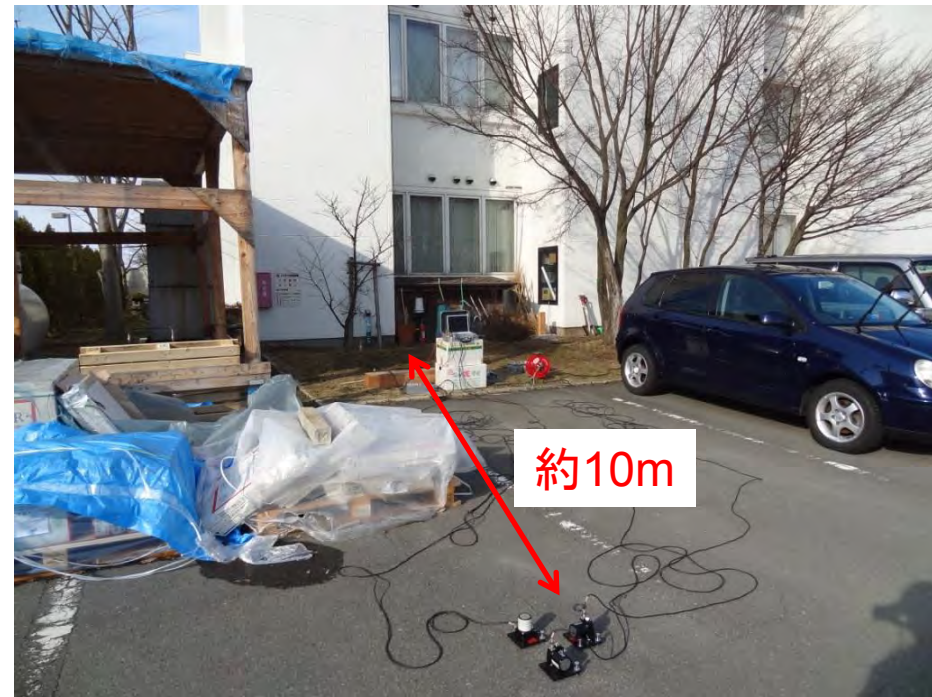
地盤上に設置した速度計
